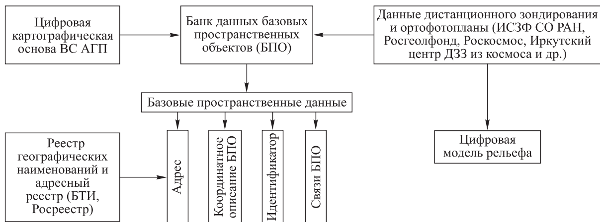
Рис. 3. Создание БПД на основе ортофото- и картографических материалов.
